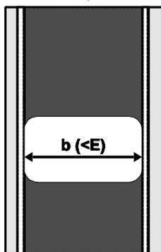
**Abb. 3: Ausschnitt, mit Isolierband abgedeckt**
